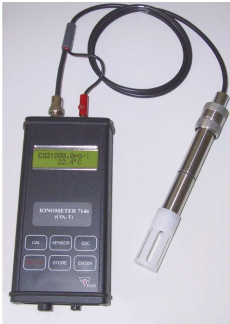
Abb. 2: Kohlendioxid-Handmessgerät mit elektrochemischem CO 2 -Sensor
